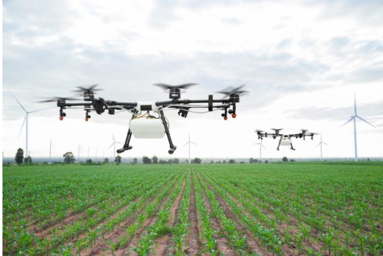
Imagen 6. Aeronave no tripulada, especializada en la aspersión de productos químicos.
